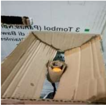
gambar 4. 2 pemasangan sensor proximity pada penampung tempat pemilah sampah
